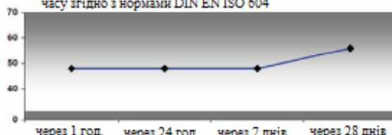
Зміна міцності матеріалу на стиск (Н/мм 2 ) упродовж часу згідно з нормами DIN EN ISO 604
